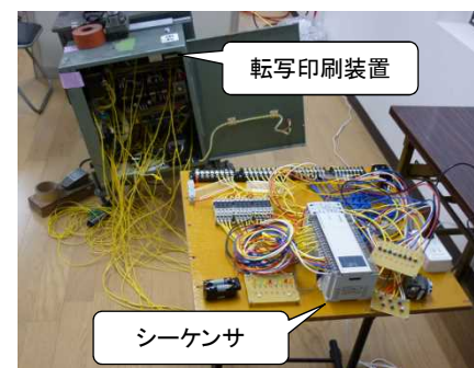
シーケンサと特殊印刷装置の接続状態
