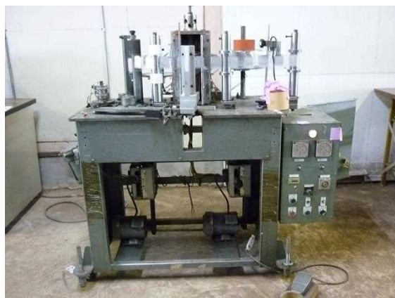
今回対象の特殊印刷装置(上)と転写印刷部(右上)及び制御盤内部(右)
