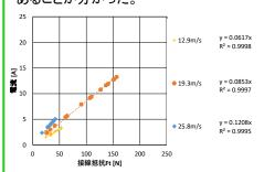
主軸電流と接線抵抗の関係(砥石周速度)
