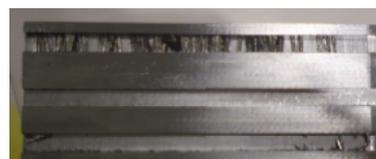
図15:10枚刃工具を用いた加工溝
