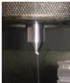
図6:首径3mm工具折損
