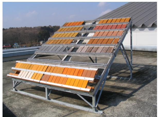
図1 暴露架台
