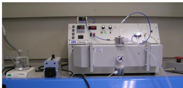
図 1 試作したゼオライト連続合成装置
