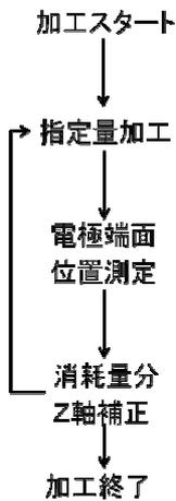
図15 電極長補正プログラム
