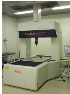
図1:三次元座標測定機の外観
