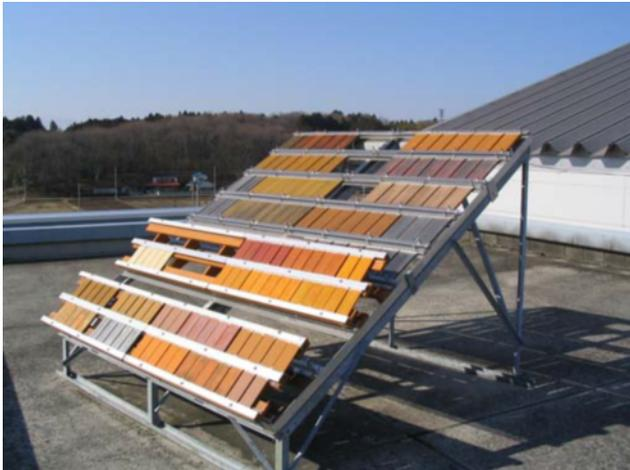
図1 暴露架台
