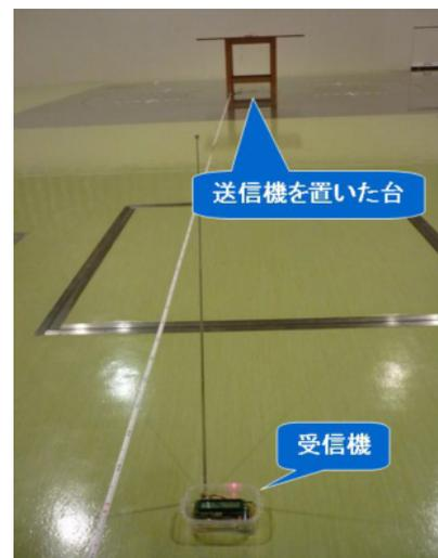
図5 センサモジュールの通信距離測定
