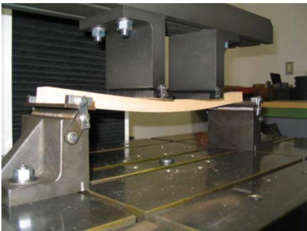
図2 縦接ぎ試験体の4点曲げ試験
