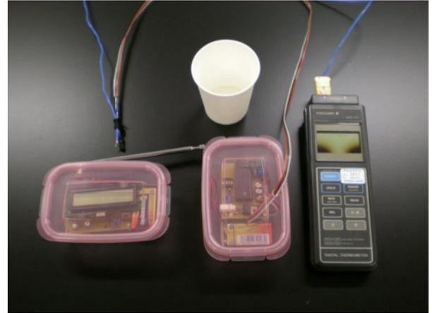
図3 IC温度センサの性能試験
