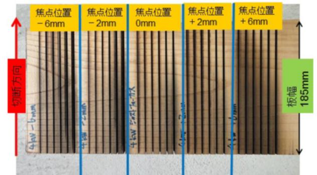
図 6 焦点位置の違いによる切断後の表面状況
