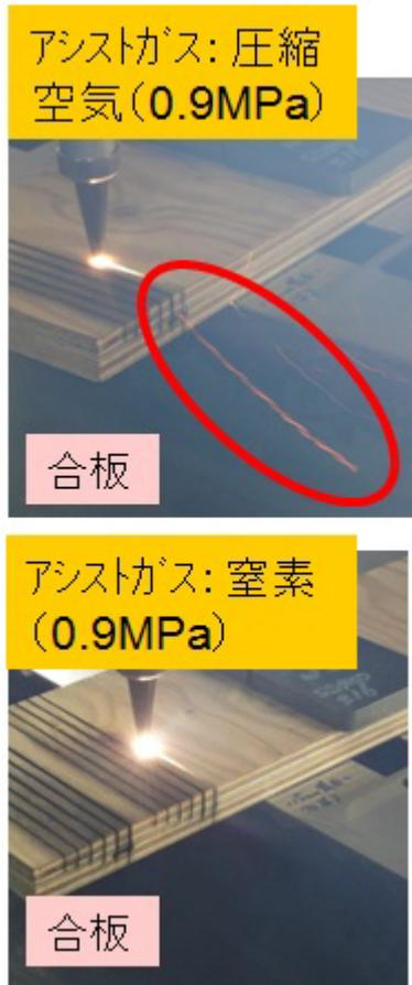
図 5 アシストガスの違いによる切断時の様子
