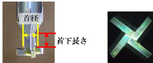
図1:T型スロット加工工具の外観
