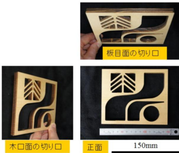
図7 榎木県章の形状に加工した試作品（板厚 10mm）
