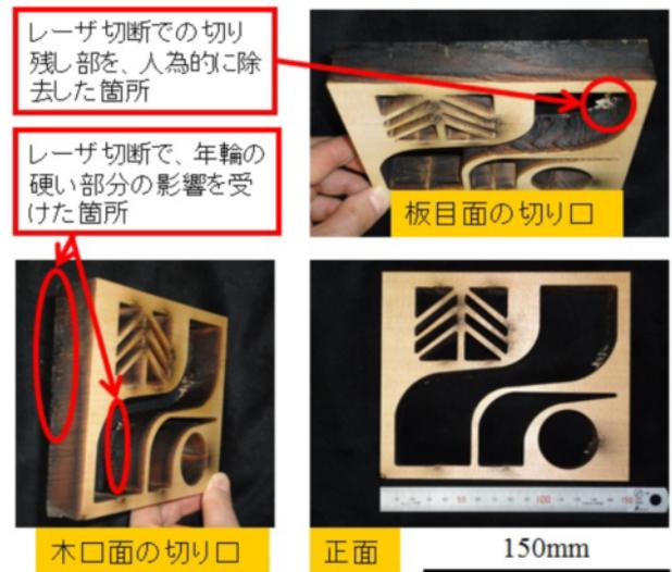
図8 榎木県章の形状に加工した試作品（板厚 25mm）
