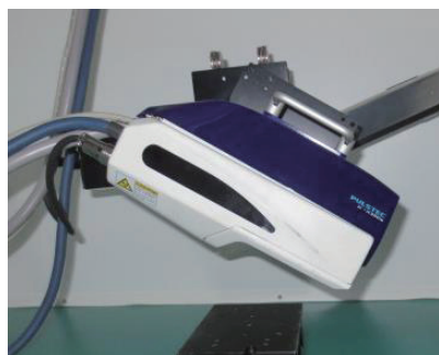
図2 ポータブル残留応力測定装置 (パルステック工業(株) 製 μ-X360)
