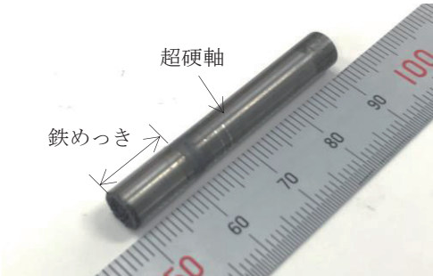
図2 鉄めっき砥石外観（ツルーイング後）
