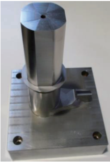
図7 3Dプリンタで作製した試作工具 (ベースプレート切断前)
