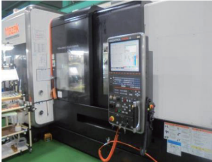
図4 複合旋盤 （ヤマザキマザック INTEGREX i300S）
