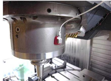
図3 加速度センサ主軸設置
