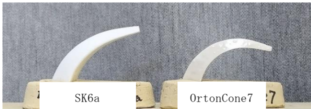
図 1 焼成試験の熔倒角度
