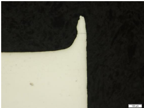
図2 金属顕微鏡で撮影したばり
