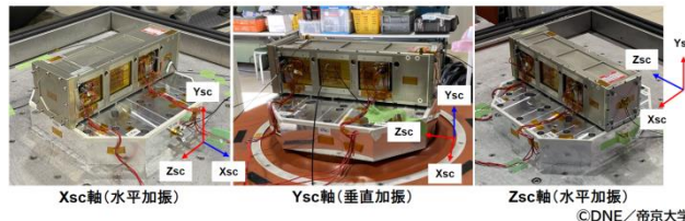
図7 認定試験(QT)レベル振動試験の様子
