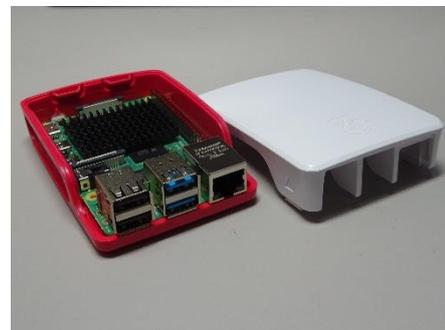
図8 使用したRaspberry Pi 4 Model B
