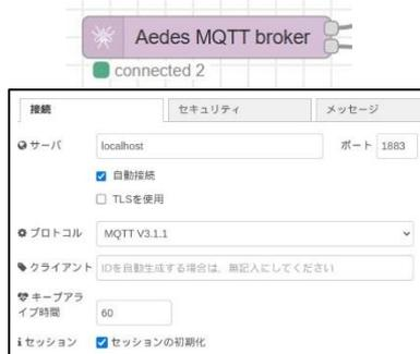
図 11 mqtt-broker ノードの設定
