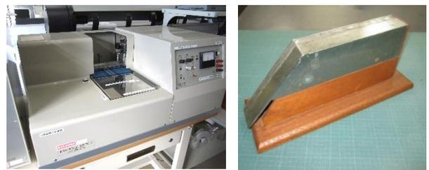
KES FB-2 純曲げ試験機 カンチレバー形試験機
