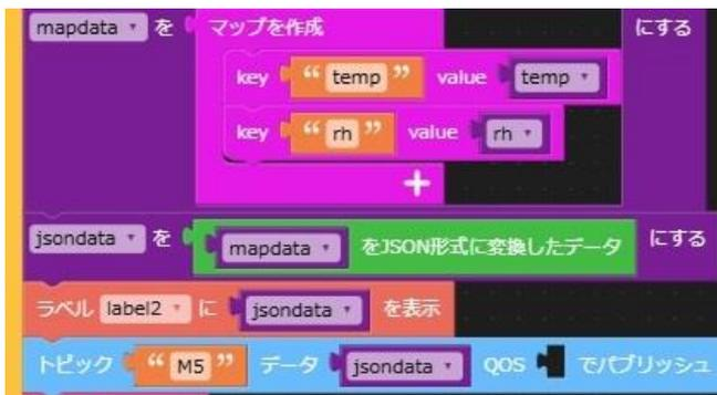
図6 JSON形式への変換と送信
