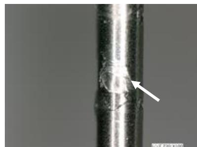
図12 細孔内面UV2時間照射サンプルにおける引き抜き試験後のカメラ表面(図中の矢印は凝集破壊した接着剤を示す)
