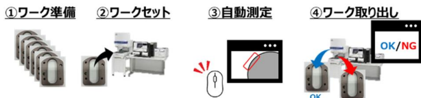
図5 手作業による検査工程の測定手順
