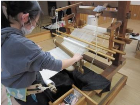
図7 地機による製織
