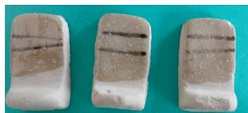
図 5 焼成テストピース（試作並白釉）
