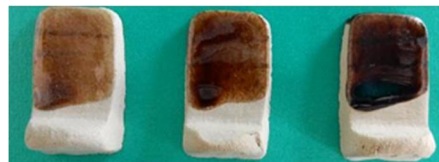
図 7 焼成テストピース (試作飴釉)
