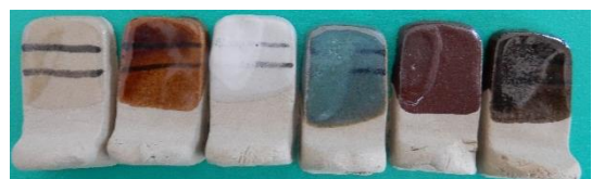
図3 益子焼伝統釉の焼成テストピース
