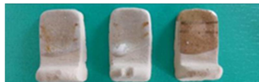
図4 焼成テストピース(試作並白釉) (左から：①、③、⑥)
