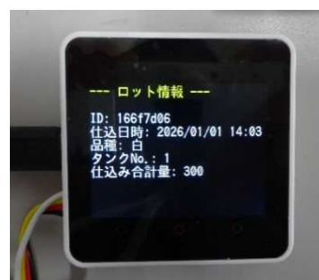
図8 M5Stack での情報表示
