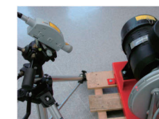
＜モータの異常検査＞
