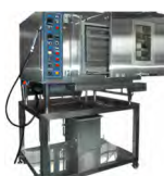
水蒸気加熱装置
