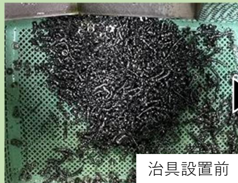
装置内のカゴに排出された製品と切りくず
