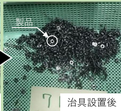
装置内のカゴに排出された製品と切りくず
