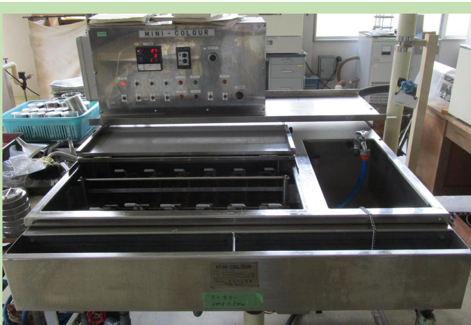
染色に使用した装置（染色機（試験用））
