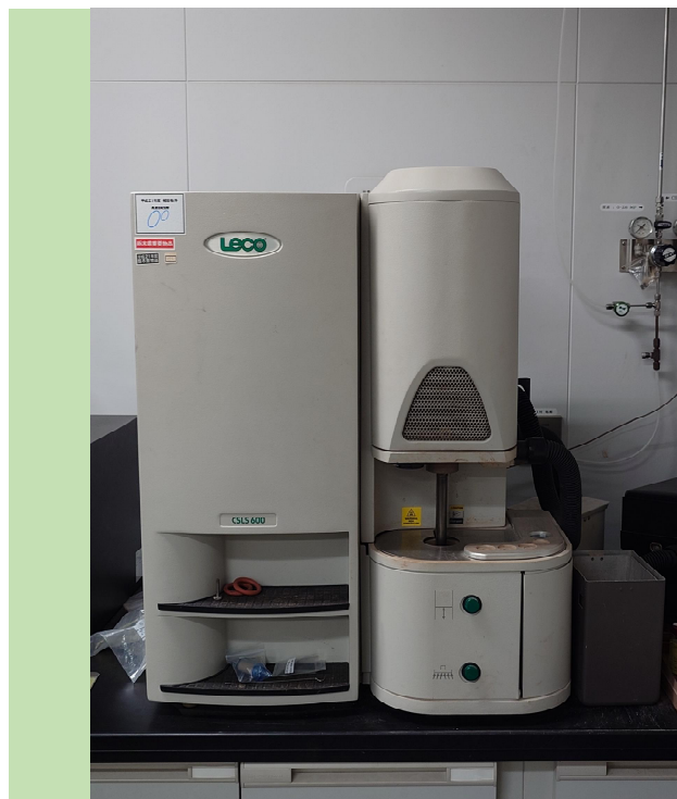
使用した装置 炭素硫黄同時分析装置
