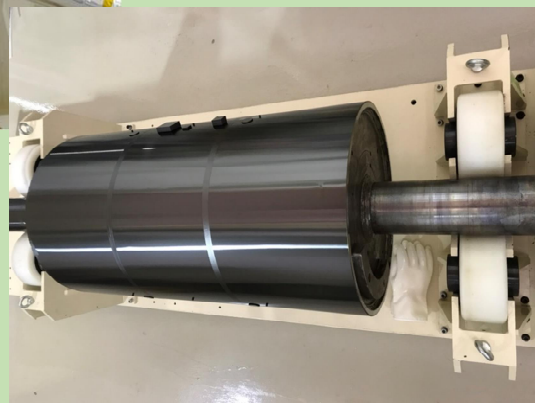
成膜品の写真 （全長約2m×φ600mm） 成膜前（上図） 成膜後（右図）
