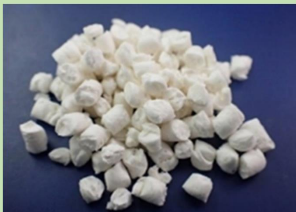
高濃度CeF複合樹脂ペレット (上図) 高濃度CeF複合樹脂成形品 (右図) ※いずれも50% CeF含有
