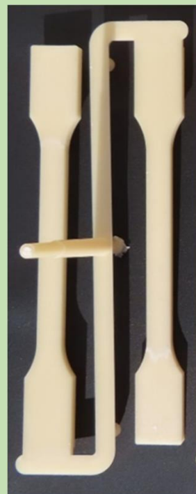
高濃度CeF複合樹脂ペレット (上図) 高濃度CeF複合樹脂成形品 (右図) ※いずれも50% CeF含有
