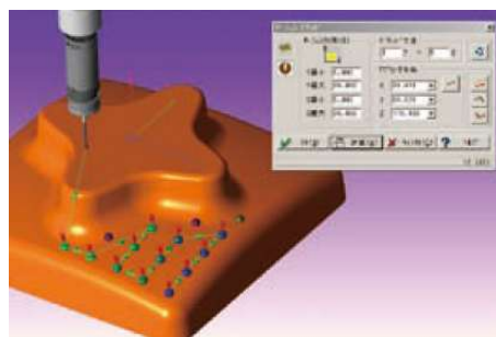
タッチプローブによる測定 MCOSMOS (CAT100S)
