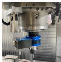
マシニングセンタなどの工作機械の主軸に取り付け、回転工具の刃先に作用する切削力を測定します。
