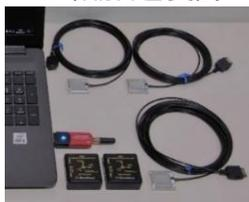
機械等の振動箇所に取り付け、3軸（x, y, z）方向の加速度を計測します。
