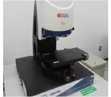
接触式及び非接触式を使い分けることで、様々な製品の二次元・三次元表面粗さを測定します。
