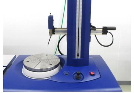
機械部品の軸などについて、円周方向や軸方向の半径の変化を測定します。
