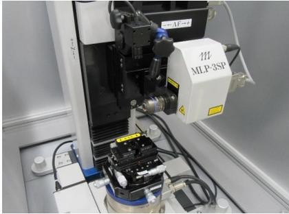
照射したレーザ光の焦点距離を基準として表面粗さ、歯車形状など多様な輪郭形状を測定します。
