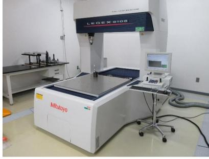
機械部品等の寸法、幾何公差、輪郭形状を高精度に測定します。
