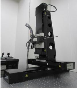
円筒内面や深溝形状などに細長い棒状の非接触センサを差し込み、寸法や形状などを測定します。
