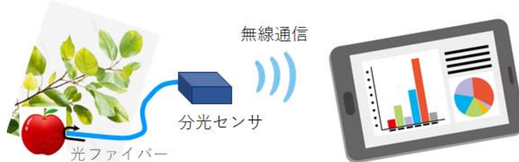
図2. 単一光ファイバ小型分光器を用いた農作物のその場計測
