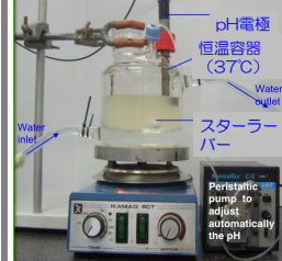
Fig. 5 In vitro模擬消化試験 恒温容器内で、生体内の消化系を簡単に再現し、体内における食品の健康機能性やバイオアベイラビリティを評価しています。
