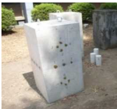
大型コンクリート試験体
