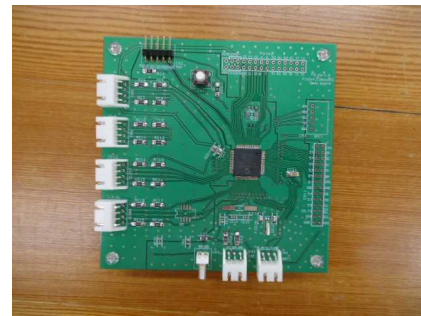
図4 作製したアナログ回路基板
