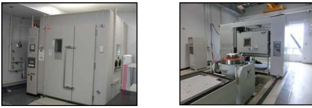
(a) 電子機器用試験槽 (b) 複合環境試験装置 図 2 稼働対象設備
