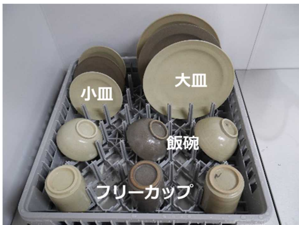
図2 試験用陶器の配置
