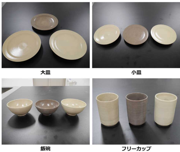
図1 食洗機耐久性試験用陶器 (左から益子水簸土, 益子赤土, 益子強化土)
