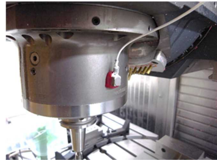
図3 加速度センサ主軸設置
