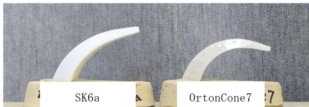
図 1 焼成試験の熔倒角度
