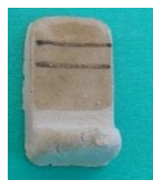
図 6 焼成テストピース (試作並白釉薬: ⑮)
