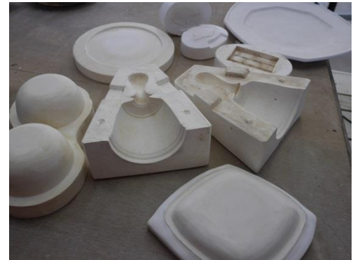
石膏型による陶磁器製造
