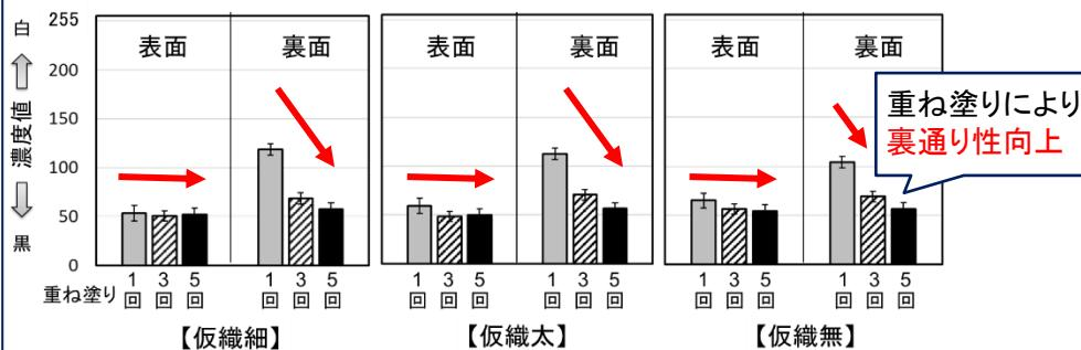
いずれの試料も同様の傾向 ⇒ 改造した櫛筵により**仮織を省略可能**
