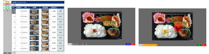
図3 目視検査用ソフトウェア画面例
