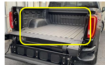
図1 量産車における熱可塑性CFRP採用例 引用: BENEC
