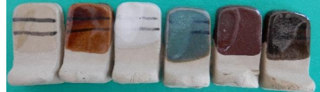
図2 益子焼伝統釉の焼成テストピース (左から:並白釉、飴釉、糠白釉、糠青磁釉、柿釉、黒釉)
